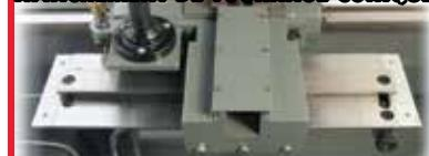
L'Attachement conique doit être commandé avec le tour à métal
